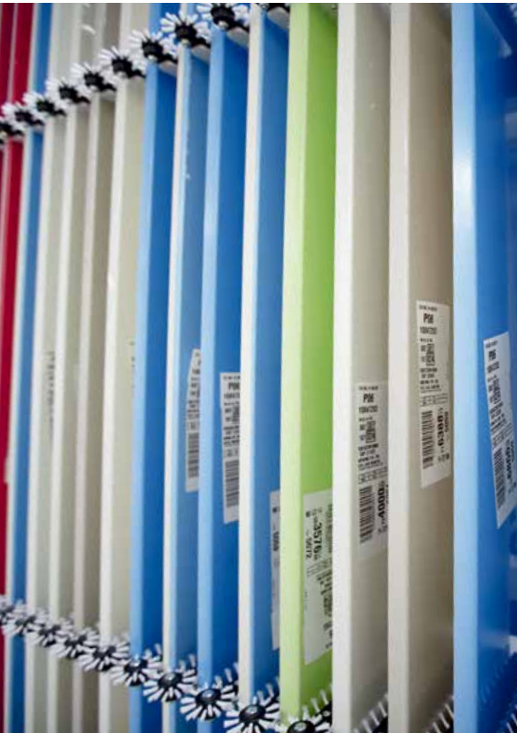
每一个部件都可以通过唯一的条形码非常明确地分配给正确的厨房家具
